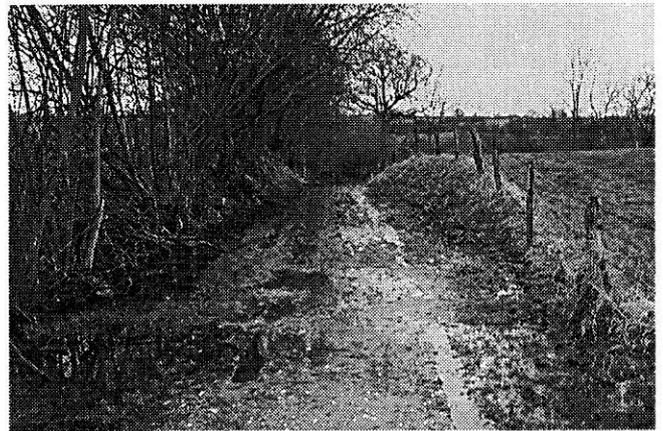
eine neue Wasserleitung zum abführen des Wassers in dem Weg verlegt. Doch leider sind die Flächen links und rechts des Weges nicht hieran angeschlossen worden, und so sammelt sich auf diesen Flächen immer noch das Wasser und überflutet dann den Weg. Ein Schacht zur Aufnahme des Oberflächenwassers sowie die Drainierung einer der Flächen und der Anschluss an die vorhandene Abwasserleitung soll jetzt Abhilfe schaffen.
